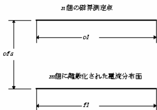
図 1.磁界測定から電流分布を探索するモデル
