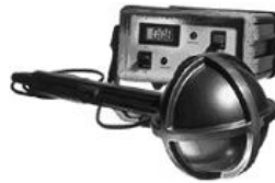
図 4.4 市販の 3 軸磁界プローブ BMM5 直径 15cm
